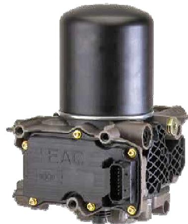
**Внимание!** При замене электронного модуля подготовки воздуха необходимо перенести специальные данные из старого электронного блока в новый блок. Перенос данных и сброс сервисного индикатора должны проводиться специально обученным персоналом и только при помощи диагностического оборудования NEO Knorr-Bremse. Установка и программирование нового модуля EAC с помощью оригинальных диагностических программ Volvo и Renault **невозможна**.
