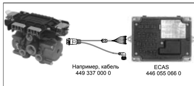
В данном примере показан кабель, использующийся при конфигурации ABS 4S/3M. С конфигурациями 4S/2M или 2S/2M используется кабель 449 336 000 0.
